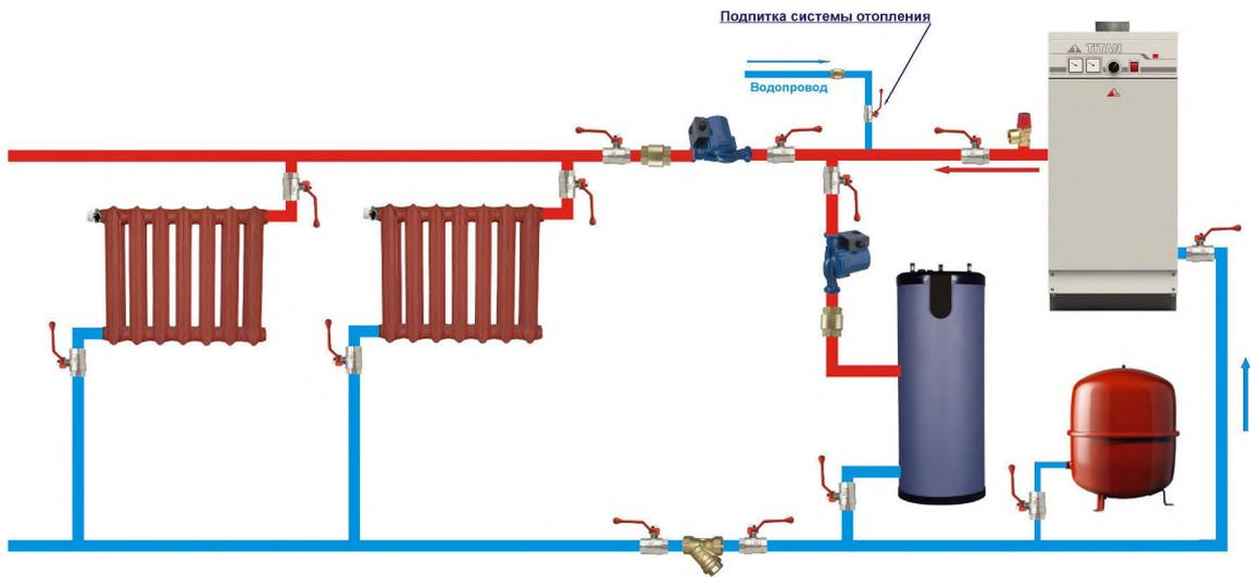
Рисунок 7. Схема подключения котла с принудительной циркуляцией теплоносителя.
