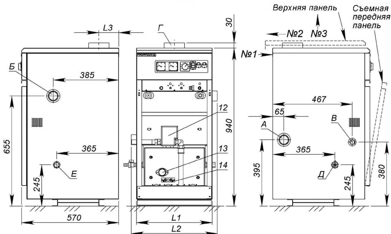
Рисунок 2. Внешний вид, габаритные и присоединительные размеры котла TITAN Z. Вид спереди показан без съемной передней панели котла.
