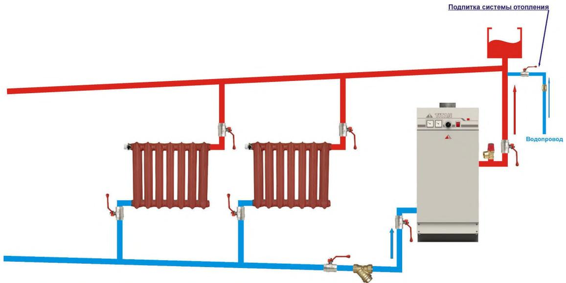
Рисунок 8. Схема подключения котла с естественной (атмосферной) циркуляцией теплоносителя.
