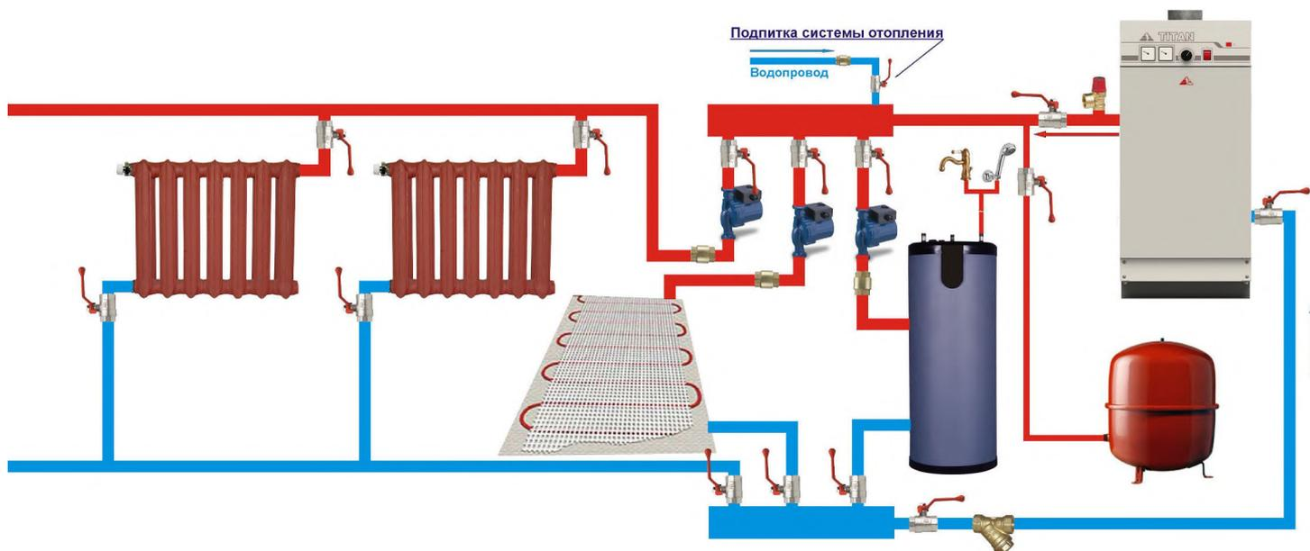
Рисунок 6. Схема подключения котла с общим коллектором.
